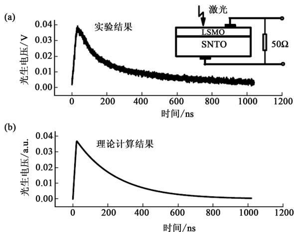
图 4 (a)实验和(b)理论计算得到的 LSMO/SNTO 光电效应随时间的演化过程. 激光在 0ns 开始照射, 在 20ns 停止. 图中曲线的峰值在 40ns 的位置. 图引自文献[22]
