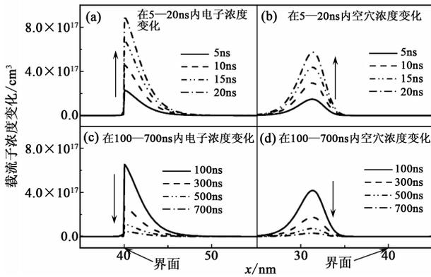
图 5 在光电效应中载流子浓度变化的演化过程。(a)和(b)分别显示了在激光照射的 5—20ns 时间内电子和空穴浓度变化的演化过程。(c)和(d)分别显示了在激光停止照射的 100—700ns 时间内和光生电压衰减过程中电子和空穴浓度变化的演化过程。图引自文献[22]
