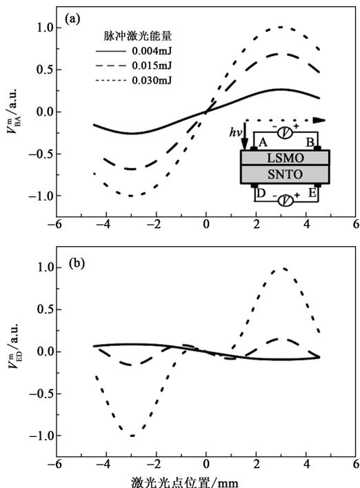
图 11 理论计算得到的在不同激光能量强度下在 LSMO 一侧(a)和在 SNTO 一侧(b)的 LPV. 插图: LPV 测量示意图. 图引自文献[17]
