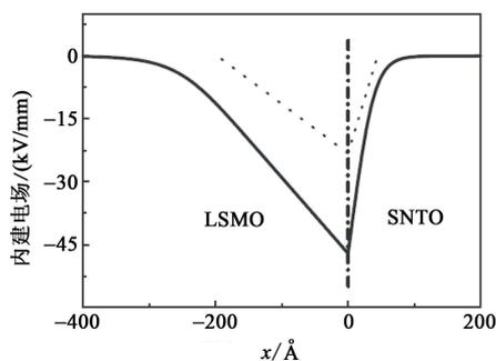
图 3 计算得出的 LSMO/SNTO 异质结在空间电荷区的电场分布图. 图中实线是 40nm 厚 LSMO 层 LSMO/SNTO 的电场分布图, 虚线是 20nm 厚 LSMO 层 LSMO/SNTO 的电场分布图. 竖直虚线表示 LSMO/SNTO 异质结界面的位置. 图引自文献[21]
