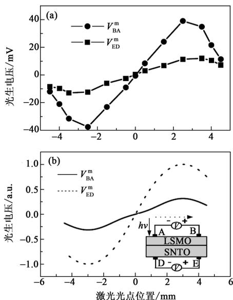
图 9 (a) 实验测得的和(b)理论计算的 LSMO/SNTO 异质结中峰值横向光电电压  $V_{BA}^m$  和  $V_{ED}^m$  随着  $x$  方向激光入射位置的变化关系图. 插图: LPV 测量示意图. 图引自文献[17]
