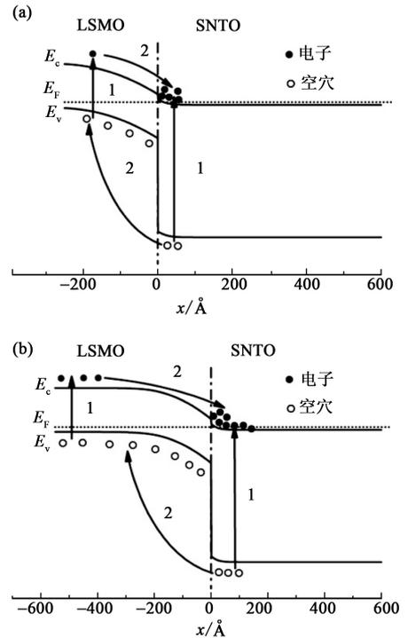
图 2 超薄 LSMO 层(a)和一般薄 LSMO 层(b)的 LSMO/SNTO 异质结的能带结构图和载流子运动示意图. 水平轴对应于空间电荷区的生长方向. 图引自文献<sup>[21]</sup>
