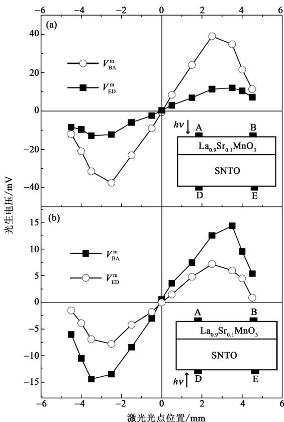
图 8 激光由 LSMO(a)、SNTO(b)照射 LSMO/SNTO 异质结, 峰值横向光电压  $V_{BA}^m$  和  $V_{ED}^m$  随着  $x$  方向激光入射位置的变化关系图. 插图为 LPV 的测量示意. A ( $-3\text{mm}$ ), B ( $3\text{mm}$ ), D ( $-3\text{mm}$ ) 和 E ( $3\text{mm}$ ) 表示电极. 图引自文献[16]
