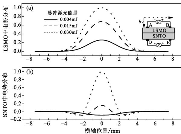
图 10 理论计算得到在不同激光能量强度下 LSMO/SNTO 异质结在 LSMO 一侧(a)和在 SNTO 一侧(b)时的电势能分布图. 插图: LPV 测量示意图. 图引自文献[17]
