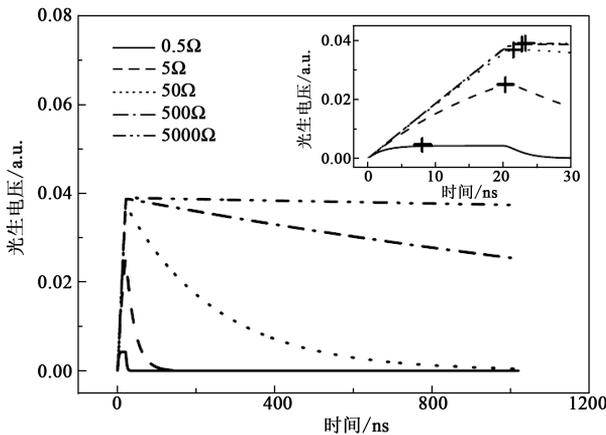
图 6 计算得出的在并联电阻大小不同情况下,LSMO/SNT0 异质结的光生电压和时间的依赖关系.插图显示了在 0—30ns 时间内光电压上升和时间的依赖关系,光电压的峰值用十字符号表示.图引自文献[22]
