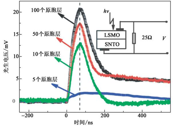
图 1 LSMO 层厚度不同的 LSMO/SNTO 异质结的纵向开路光生电压随时间的变化关系. 插图为纵向光电效应的测量示意. 图引自文献<sup>[21]</sup>
