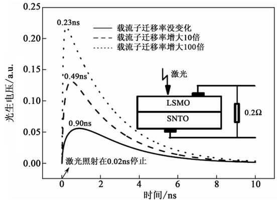
图 7 计算得到的不同载流子浓度的 LSMO/SNT0 异质结的光电效应和时间的依赖关系.激光在 0ns 开始照射,在 0.02ns 停止.图引自文献[22]
